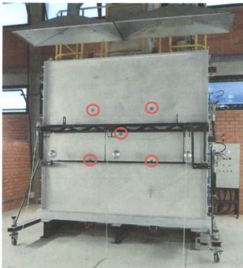
**Figura 3 – Posições dos termopares na parte externa das amostras**
