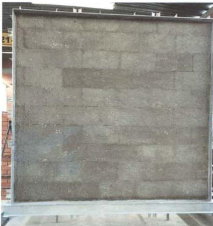
Figura 2 – Amostra com revestimento de chapisco
