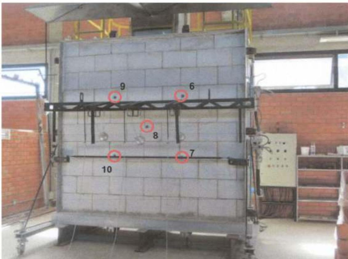
Figura 3 – Posições dos termopares na parte externa das amostras
