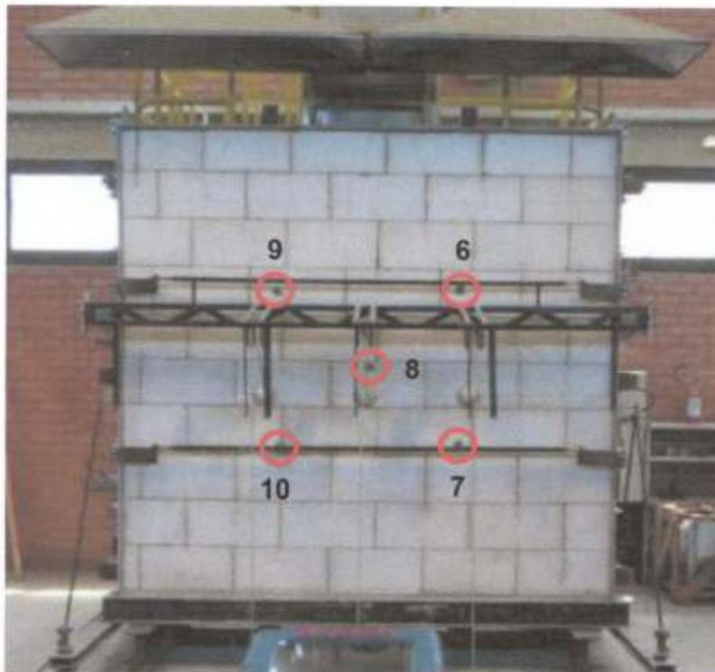
Figura 3 – Posições dos termopares na parte externa das amostras
