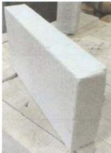
Figura 1 – Bloco de concreto celular utilizado para confecção da amostra
