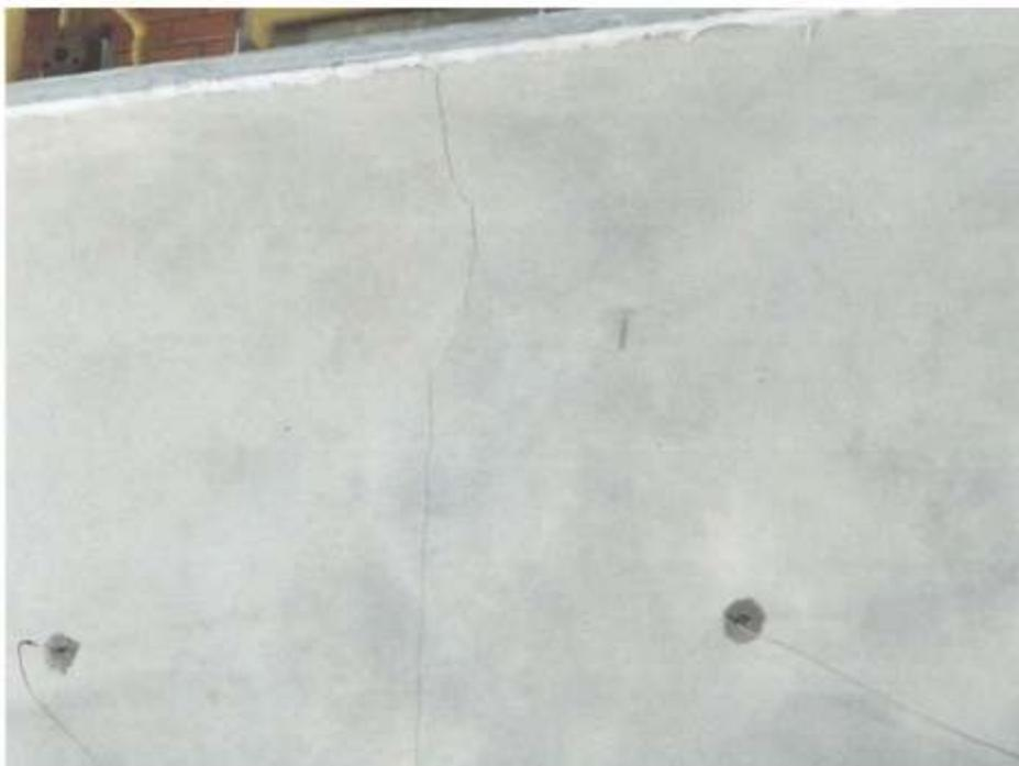
Figura 6 – Segundo ponto de fissura (6 min de ensaio)
